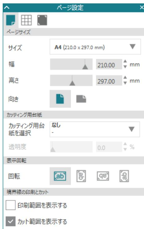
※ワークスペースのサイズ、方向を設定します。ここでは A4 サイズのカッティングフィルムをカッティング用台紙無しで設定する場合の例を説明します。
